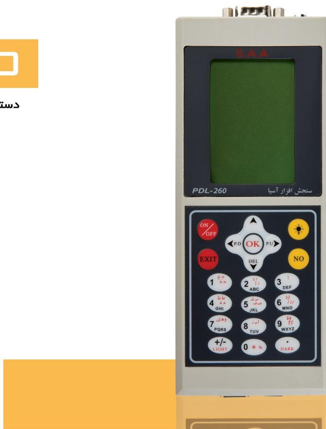
دستگاه PDL-260 جهت قرائت همزمان کنتورهای برق و آب طراحی شده است. دستگاه مذکور دارای سیستم قرائت اتوماتیک کنتورهای برق دیجیتالی از طریق پروب نوری است که بطور کامل از خطای انسانی جلوگیری می کند.
