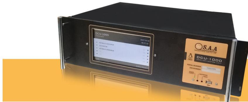
این دستگاه در کنار کنتورهای موجود در پست های فوق توزیع نصب شده و با استفاده از پورت های ارتباطی RS485، به آن ها متصل می شود و اطلاعات مورد نیاز را از طریق پروتکل های استاندارد و با سیستم های ارتباطی LAN و یا GPRS برای نرم افزار بازار برق و سیستم SCADA ارسال می نماید. با توجه به تجهیز این دستگاه به سیستم عامل لینوکس و ذخیره اطلاعات در دیتابیس، در ارسال داده هیچ تأخیری وجود ندارد و اطلاعات به صورت بلادرنگ به مرکز مربوطه ارسال می گردد.
