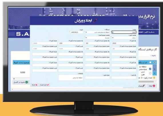
نرم افزار جامع مدیریت و بالانس اطلاعات گاز (GBIM) مبتنی بر وب بوده و به منظور کنترل از راه دور و مدیریت اطلاعات تصحیح کننده های ایستگاه های گازرسانی، طراحی و پیاده سازی گردیده است. در این سیستم با دریافت اطلاعات ایستگاه ها از سیستم اسکادا اقدامات لازم در خصوص مدیریت داده های دریافت شده صورت می پذیرد.
